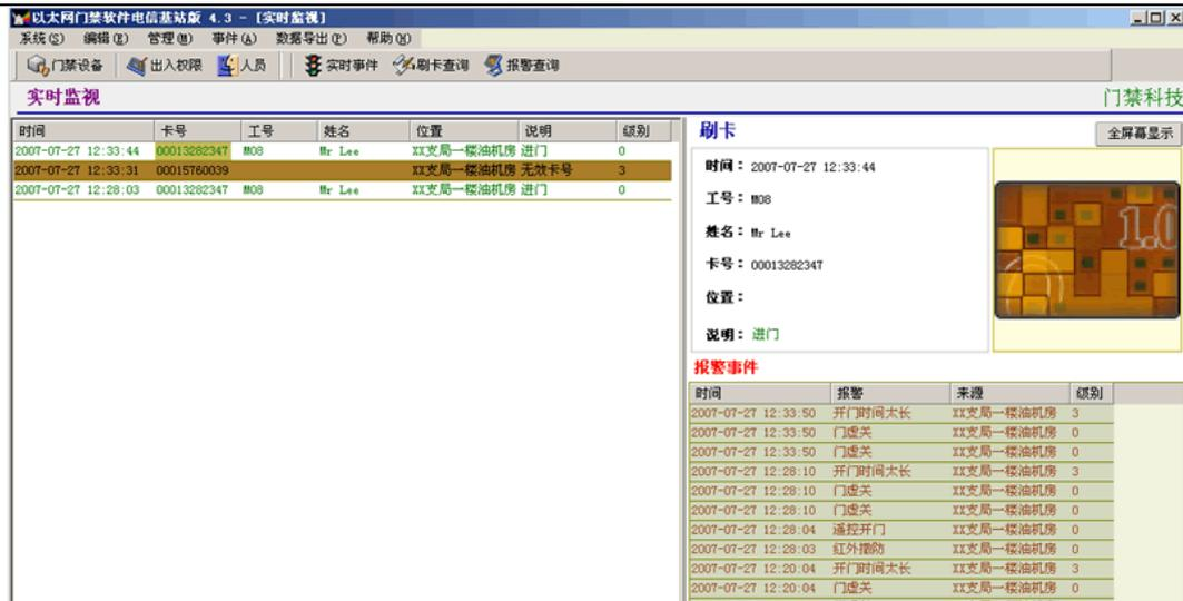
可以脱机存储刷卡记录和卡信息各 20000 条，每条记录信息中包含、卡号、时间、地点、是否通过等完整信息。如果存储满后，会挤掉最老的信息，保存最新的信息。打开软件后，数据会自动下载到数据库中，软件可以对刷卡记录进行统计处理，查看开门刷卡信息，并以 Word、Txt、Excel 等文档格式分类导出各类统计数据。
